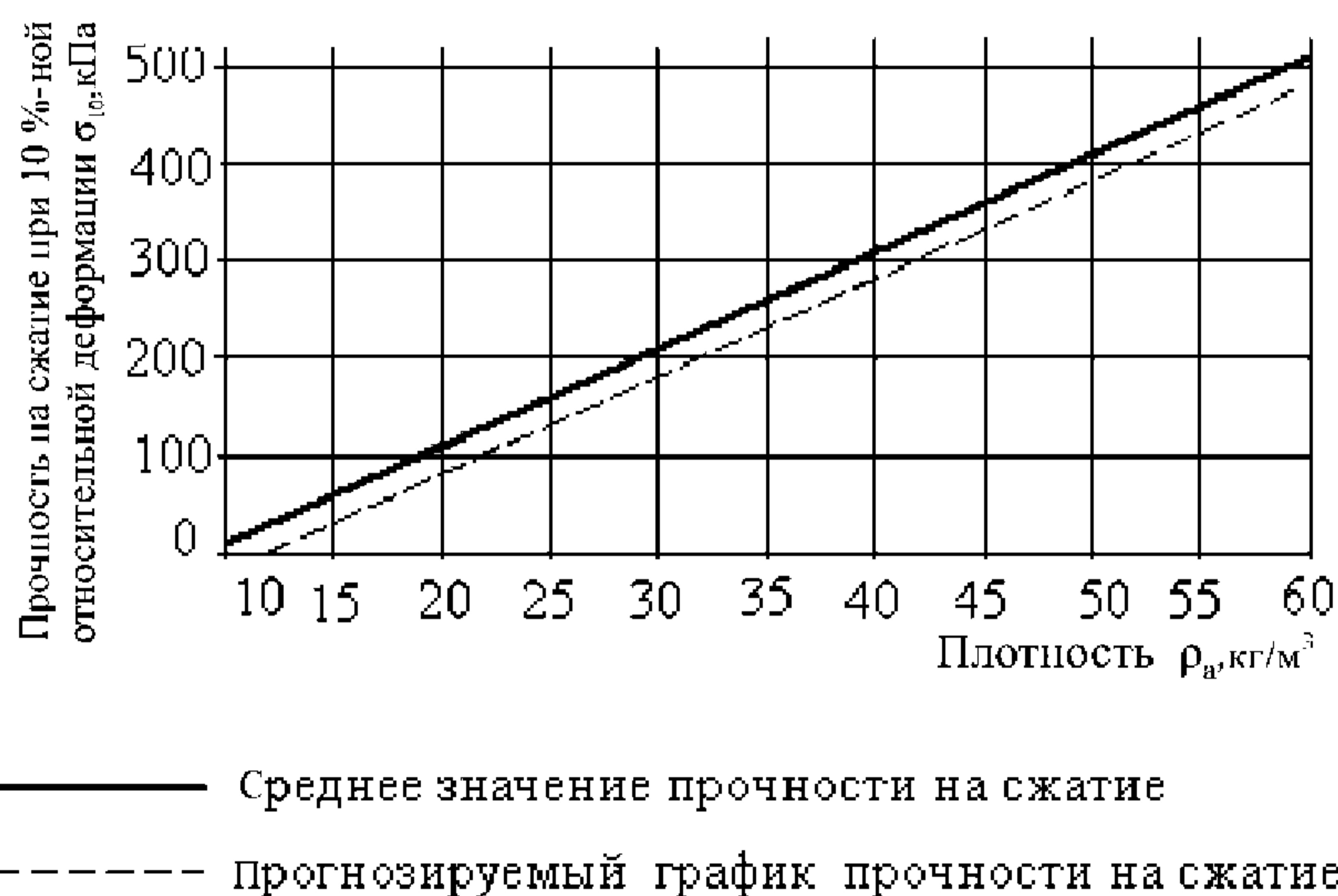
Рисунок В.1 – Зависимость прочности на сжатие при 10 %-ной относительной деформации от плотности (косвенный метод); 1 - a = 0,90 ; n = 495
